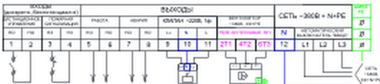
Типовая схема подключения AIRS ЩУБК-380
