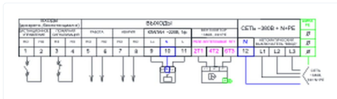
Типовая схема подключения AIRS ЩУБК-380
