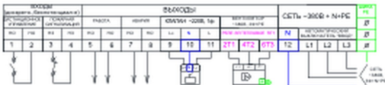
Типовая схема подключения AIRS ЩУБК-380
