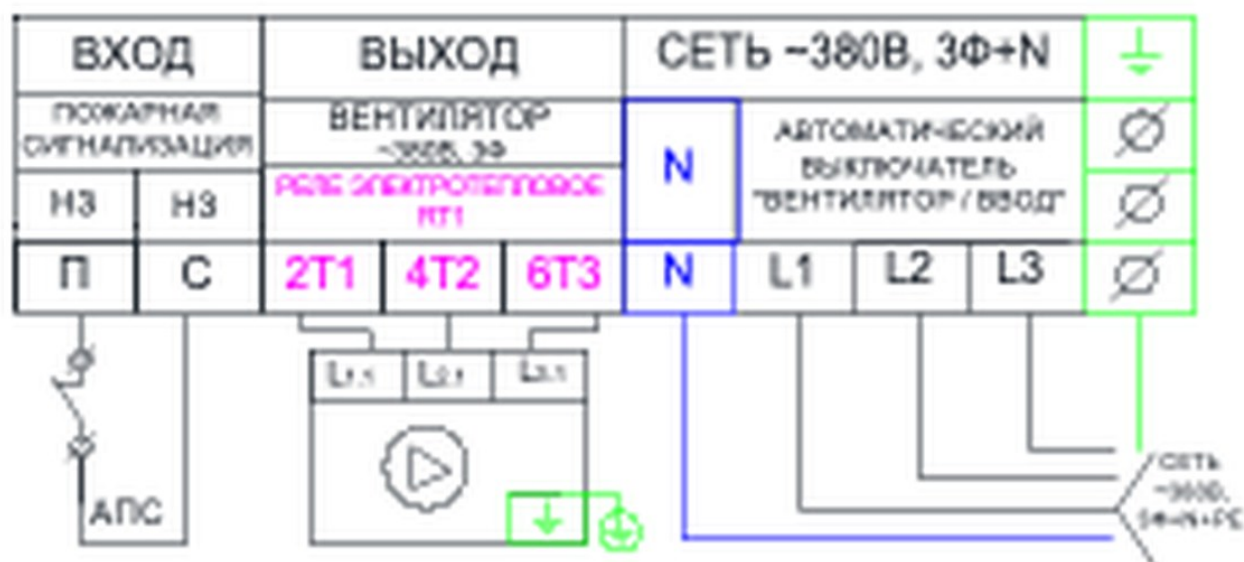
Типовая схема подключения AIRS ЩУВ-380
