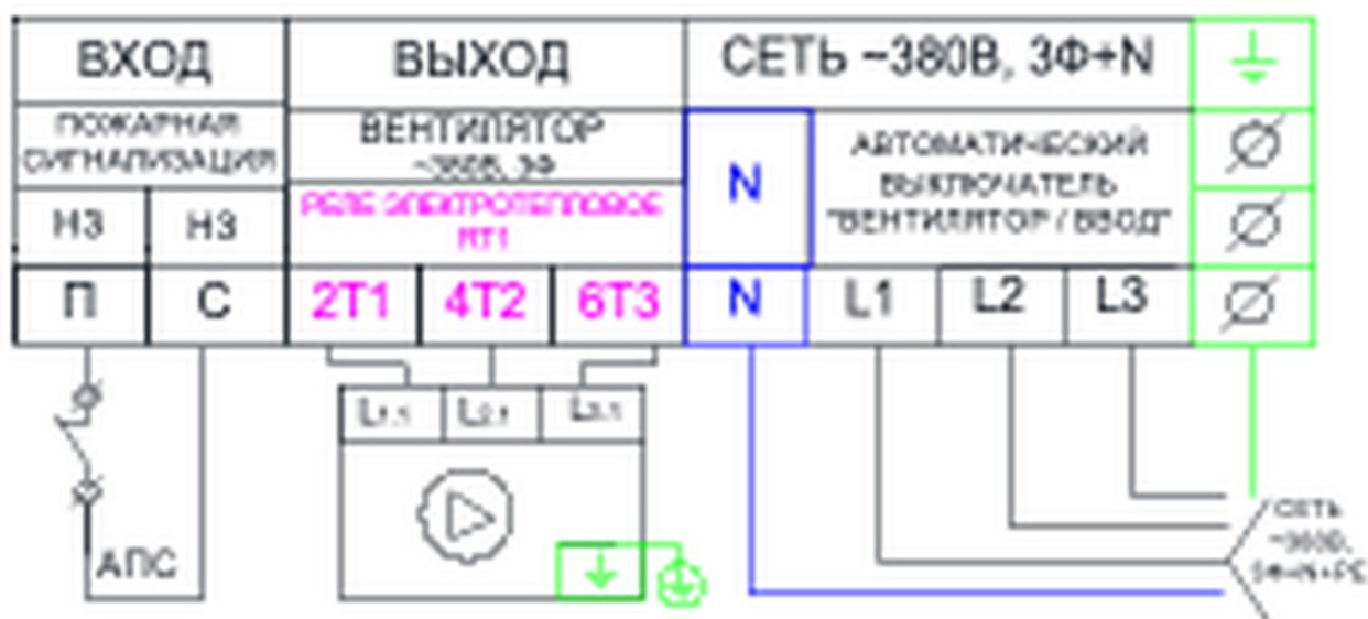
Типовая схема подключения AIRS ЩУВ-380
