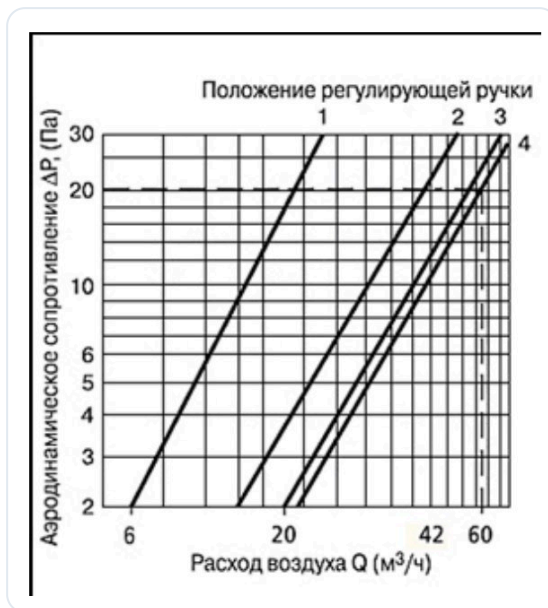
Аэродинамическая характеристика: расход воздуха в зависимости от разрежения и положения регулирующей ручки
