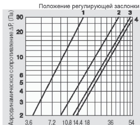
Аэродинамическая характеристика клапана при различных положениях регулирующей заслонки
