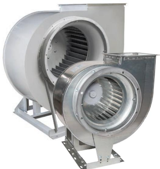
Вентиляторы серии ВЦ 14-46-ДУ для противопожарных систем дымоудаления (ППД-систем) представляют собой радиальные вентиляторы с загнутыми вперед лопатками специальной формы с рабочим колесом левого или правого вращения.
