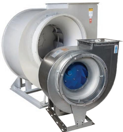
Вентиляторы серии ВР 80-75-ДУ для противопожарных систем дымоудаления (ППД-систем) представляют собой радиальные вентиляторы с загнутыми назад лопатками специальной формы с рабочим колесом левого или правого вращения.
