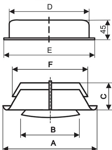
Диффузоры SR предназначены для применения в вытяжных системах вентиляции и кондиционирования. Они представляют собой потолочные воздухораспределительные элементы с плавным регулированием расхода воздуха, которое осуществляется с помощью вращения центрального диска.
