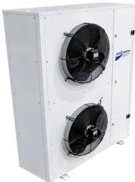
Компрессорно-конденсаторные блоки (ККБ) служат для отвода тепла в окружающую атмосферу от фреона (хладоносителя) выходящего из испарителя, путем сжатия входящих газов в компрессоре. При этом процессе поднимается температура газов фреона выше атмосферной. Отвод тепла происходит в теплообменнике под названием конденсатор в котором фреон изменяет агрегатное состояние из газообразного состояния в жидкое. Подача воздуха через конденсатор осуществляется посредством осевых вентиляторов.
