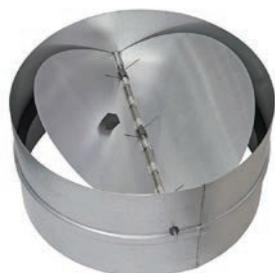
Обратный клапан КОВ с подпружинными лопастями обеспечивает автоматическое перекрытие круглых воздуховодов при выключении вентилятора. Обратный клапан может быть установлен в любом положении. Корпус и лопасти обратного клапана выполнены из оцинкованного стального листа толщиной 0,7 мм. На одной из лопастей есть вибродемпфирующий уплотнитель для предотвращения шума при открытии клапана.
